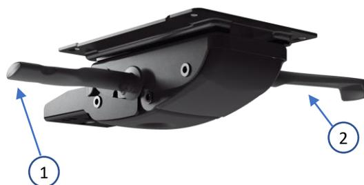
**1)** Leva di regolazione dell'altezza del sedile e di inclinazione dello schienale. Per azionarla bisogna spingerla verso l'alto, regolare l'altezza desiderata e lasciare la leva.
