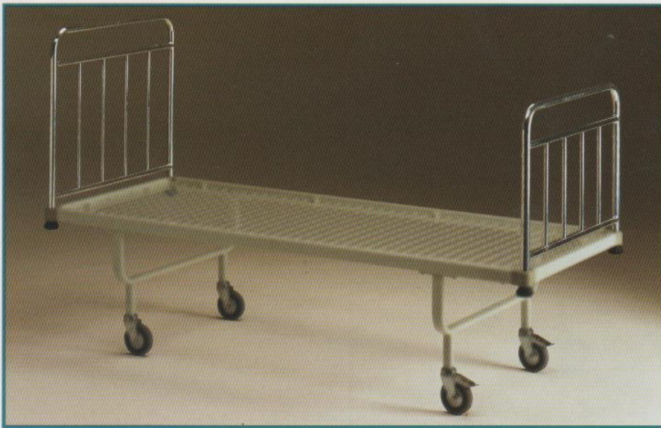
art. 511 COPPIA SPALLIERE PER LETTO DEGENZA Dim. cm. 85x46/60h. Realizzate in tubolare di lega di alluminio tipo PERALLUMAG PE 35H20, d=mm. 30x2s, lucidato a specchio, opportunamente rinforzato interamente con tubo di acciaio, d=mm. 25x2s; quattro traversini verticali, d=mm. 16x1,5s, e un traversino orizzontale, d=mm. 25x2s; applicazione alla rete ad innesto rapido con volantini di bloccaggio.
